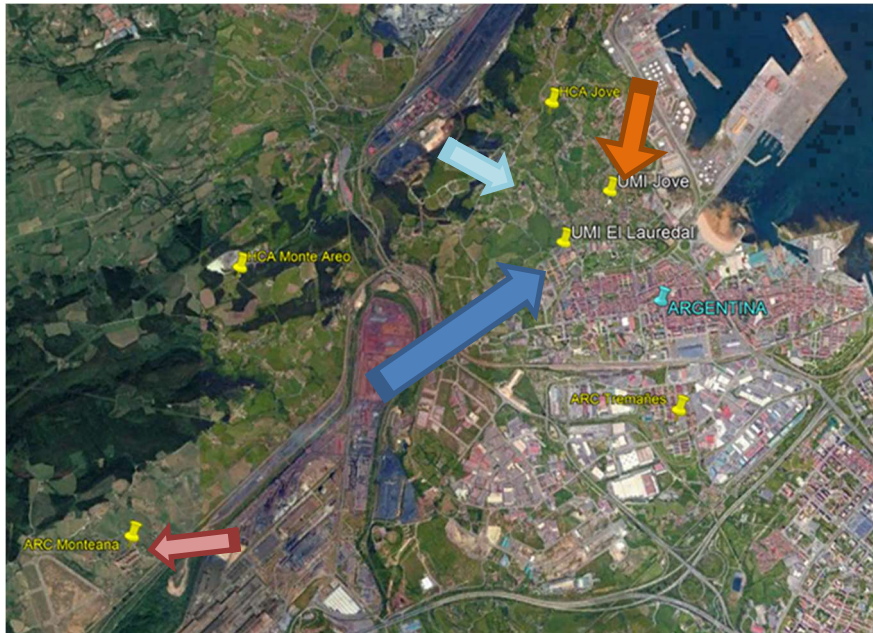
Figura 3.47. Situación de la ubicación de las estaciones citadas, respecto a los focos y direcciones de vientos predominantes
